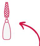
Finalize o corte passando uma lima para retirar as rebarbas do cano cortado.
